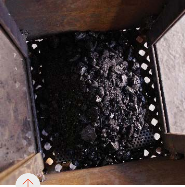
1. Test haznesindeki yanmamış kömür.
