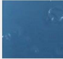
%5 hidroklorik asit içinde PVDF kaplı sac
